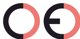
Marcatura CE contraffatta (troppo distante)
